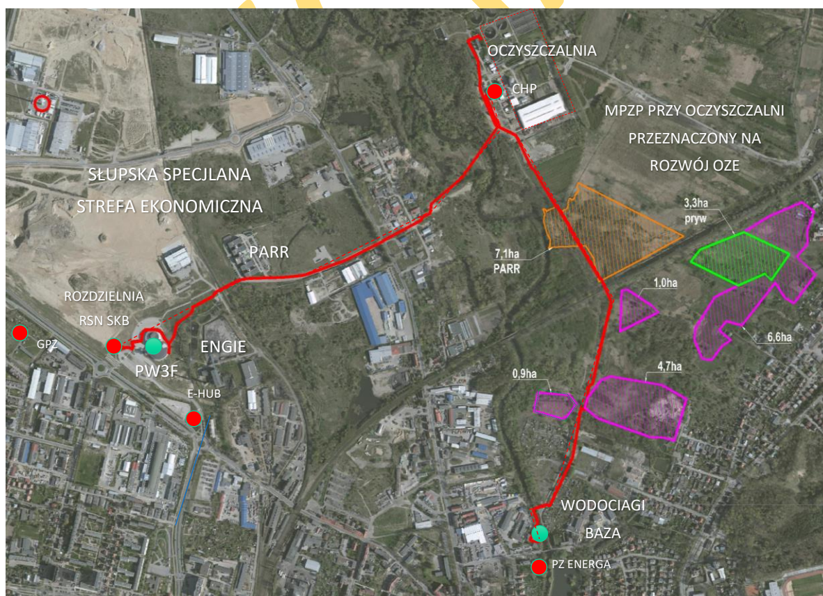
Rysunek 14 Wybudowane sieci 15 kV łączące OŚ z bazą WS i PW3F oraz terenem inwestycyjny SSSE (zakończony rozdzielnią RS SKB)
